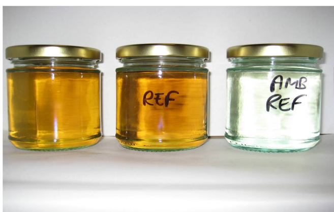
Slika 5. Uzorci sintetskog estera (MIDEL® 7131) nakon 168 h pri 140°C i referentnog uzorka pri sobnoj temperaturi
