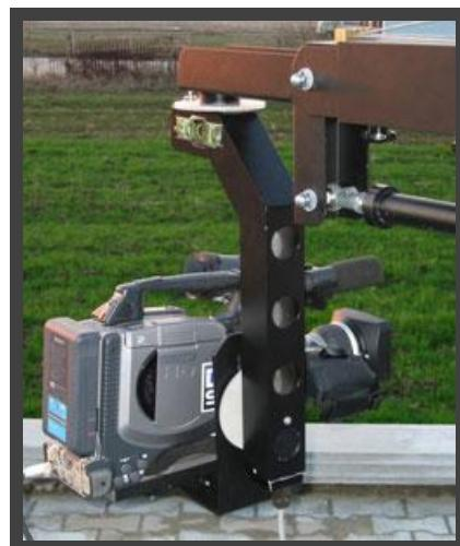
Slika 3.4.2. Robotska glava za kameru izbliza.
