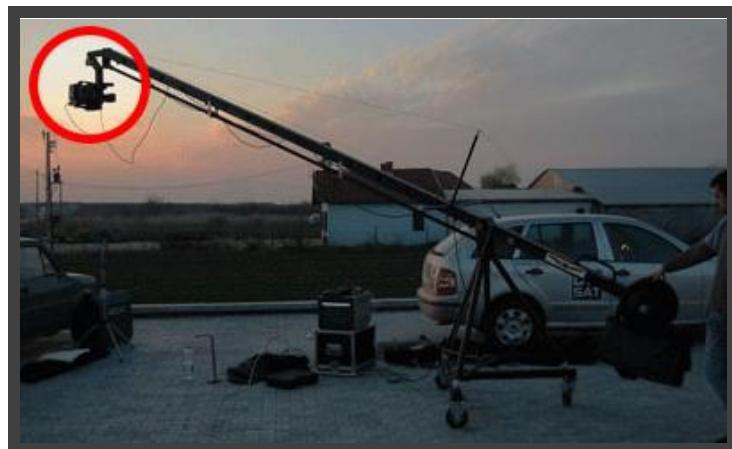
Slika 3.4.1. Robotska glava pričvršćena na vrh ruke dizalice.
