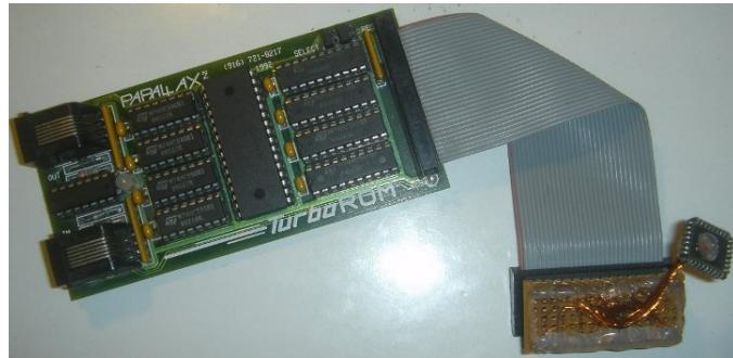
Slika 15: Korišteni TurboROM emulator s priključenim adapterom
