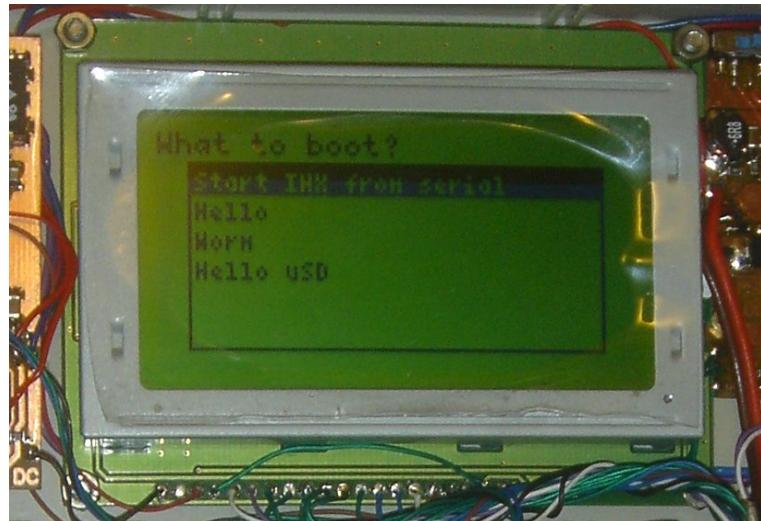
Slika 22: LCD modul prikazuje izbornik
