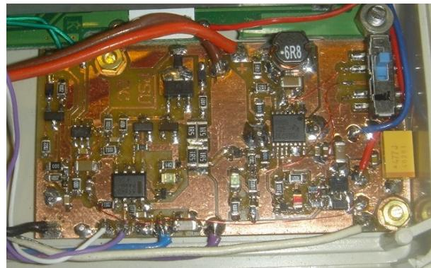
*Slika 28: Tiskana pločica za napajanje*
