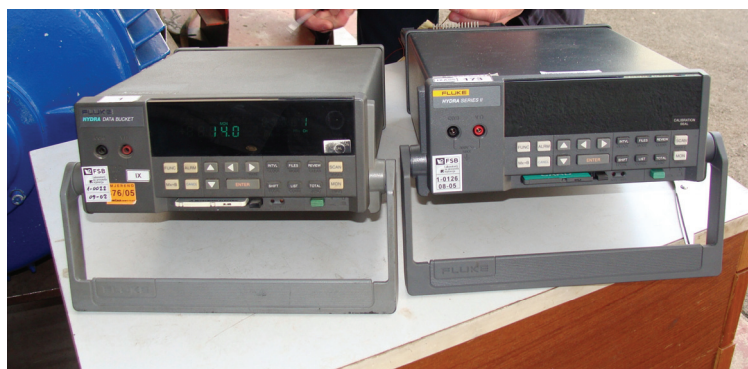
Slika 6.2. Ispitna oprema za mjerenje zagrijavanja elektromotora
