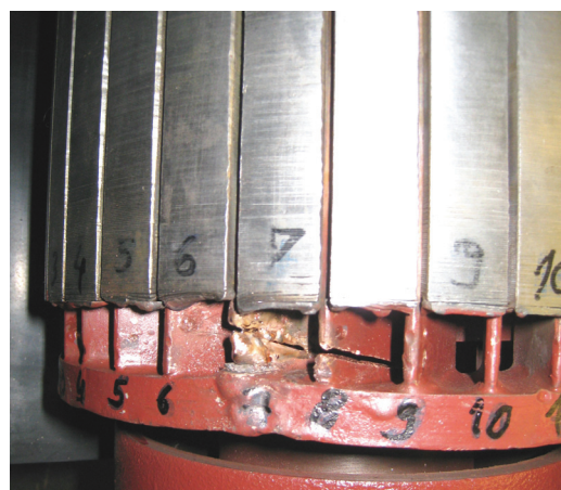
Slika G.3. Razina II oštećenja kaveza rotora
