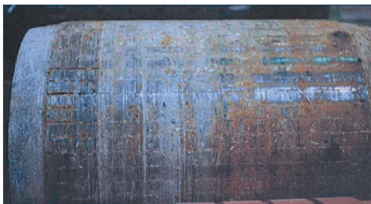
Slika E.2. Oštećenje lijevanog aluminijskog kaveza
