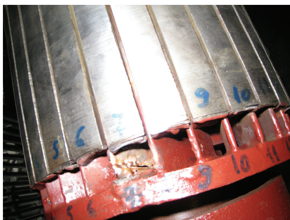
Slika G.2. Razina I oštećenja kaveza rotora
