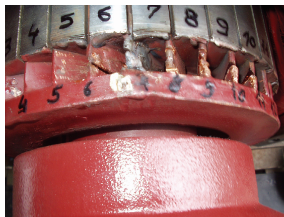
Slika G.5. Razina IV oštećenja kaveza rotora
