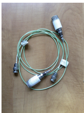
Slika H.3. Davači (pretvornici) tlaka i sustav/uređaj za mjerenje tlaka eksplozije KISTLER
