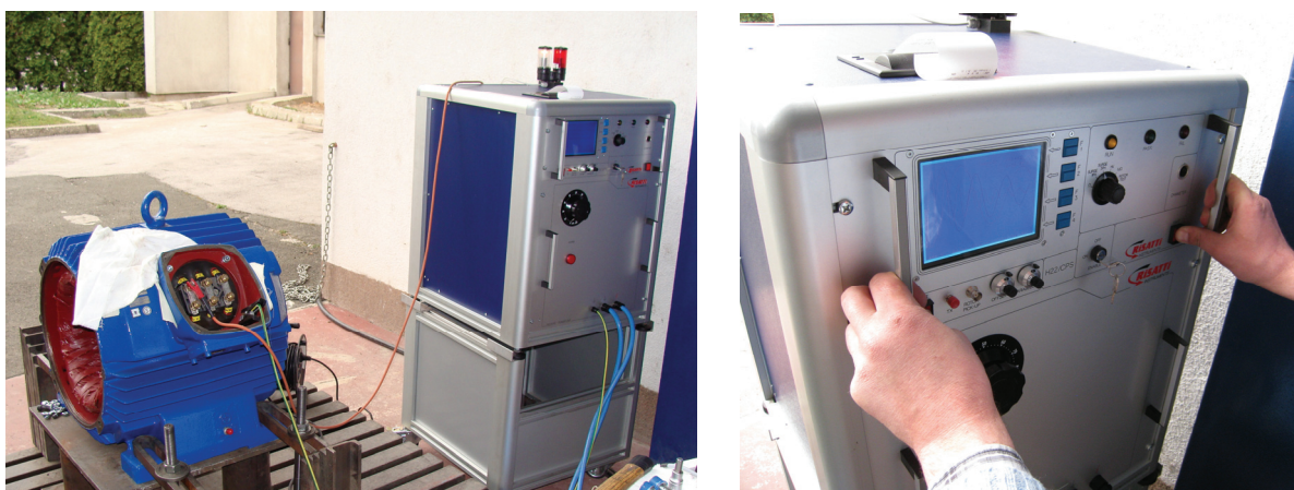
Slika F.2. Ispitni uređaj za ispitivanje udarnim naponom Risatti H22/CPS
