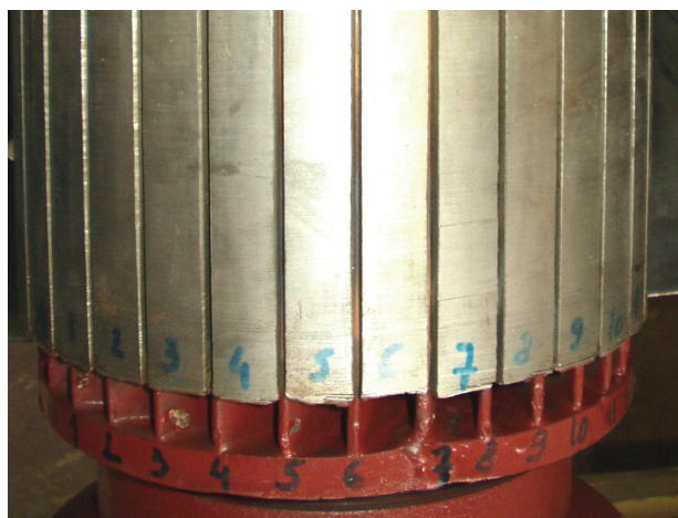
Slika G.1. Ispravan (servisiran) kavez rotora
