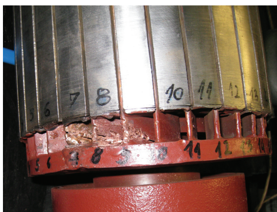
Slika G.4. Razina III oštećenja kaveza rotora
