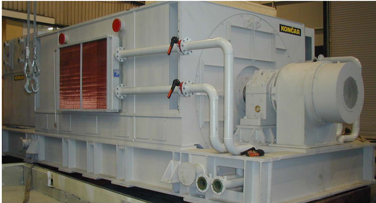
Slika 5. Ugradnja agregata 40 MVA
