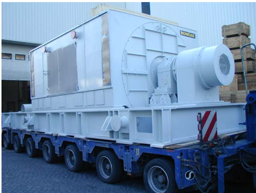
Slika 4. Transport turbogeneratora 40 MVA zajedno s temeljnom pločom
