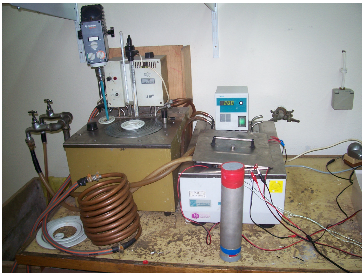
Slika 21. Eksperimentalni postav za mjerenje toplinske difuzivnosti materijala
