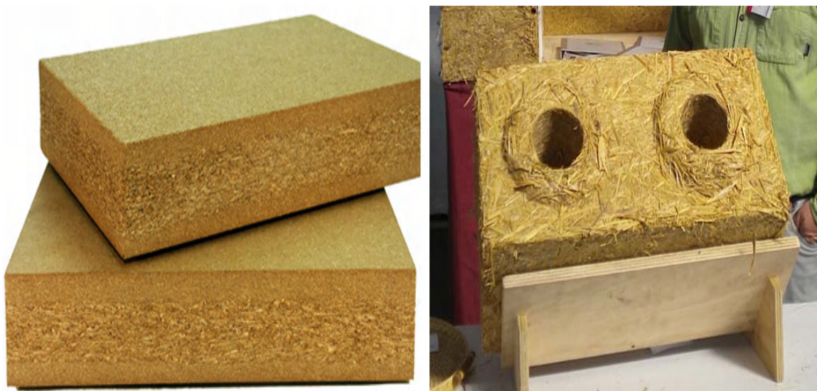
Slika 2. a) i b) Različite izvedbe građevnih elemenata od komprimirane slame
