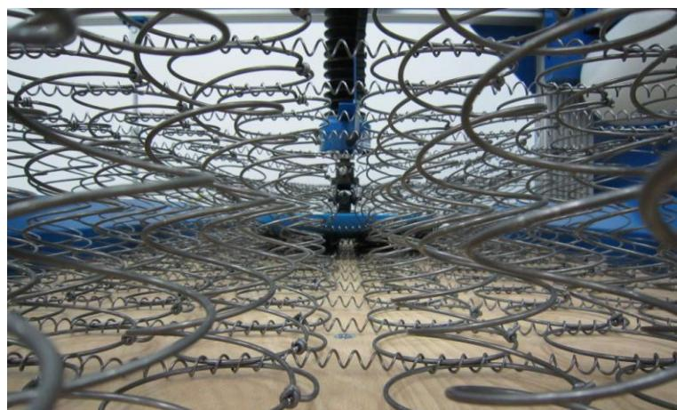
Slika 26. Mjerenje elastičnosti - utiskivanje podloška u uzorak
