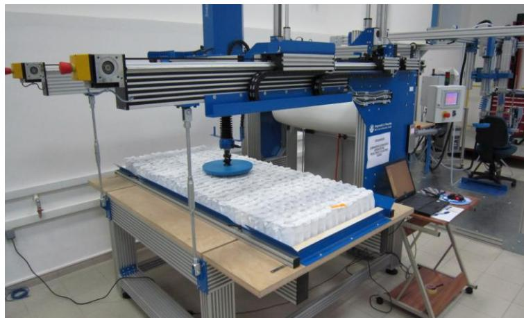
Slika 25. Uređaj za mjerjenje izdržljivosti i elastičnosti ležaja-madraca
