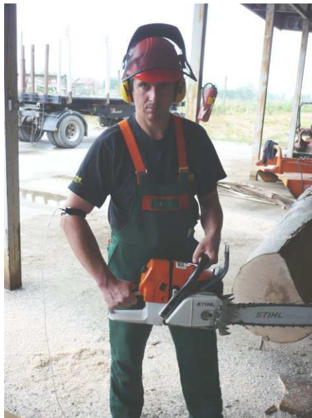
Slika 4.1. Položaj rukovatelja motornom pilom lančanicom pri mjerenju vibracija koje se prenose s ručke pile na sustav šaka-ruka prema preporukama ISO 7505-1986 (E): Forestry machinery – Chain saws – Measurement of hand-transmitted vibration I
