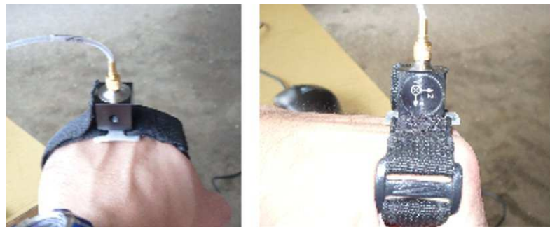
Slika 4.4. Pričvršćivanje nosača i akcelerometra na površinu ruke
