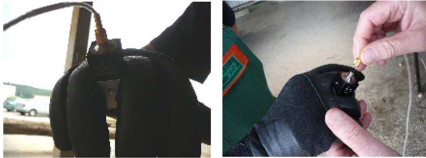
Slika 4.3. Prihvat nosača i akcelerometra za potrebe mjerenja prigušnih svojstava rukavica gdje je nosač akcelerometra smješten između prigušnog materijala i prstiju
