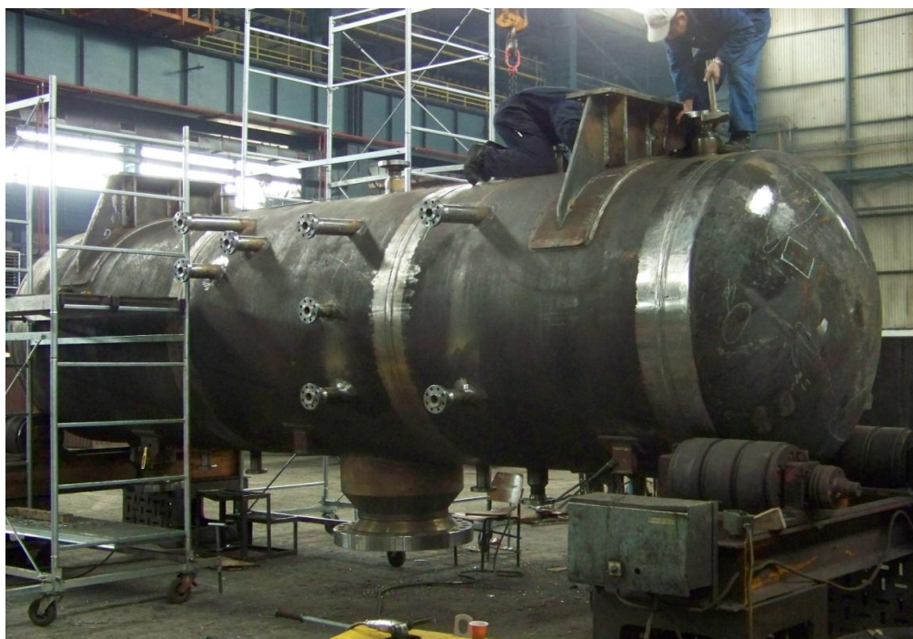
Slika 4.17 Visokotlačni separator, spajanje sedla
