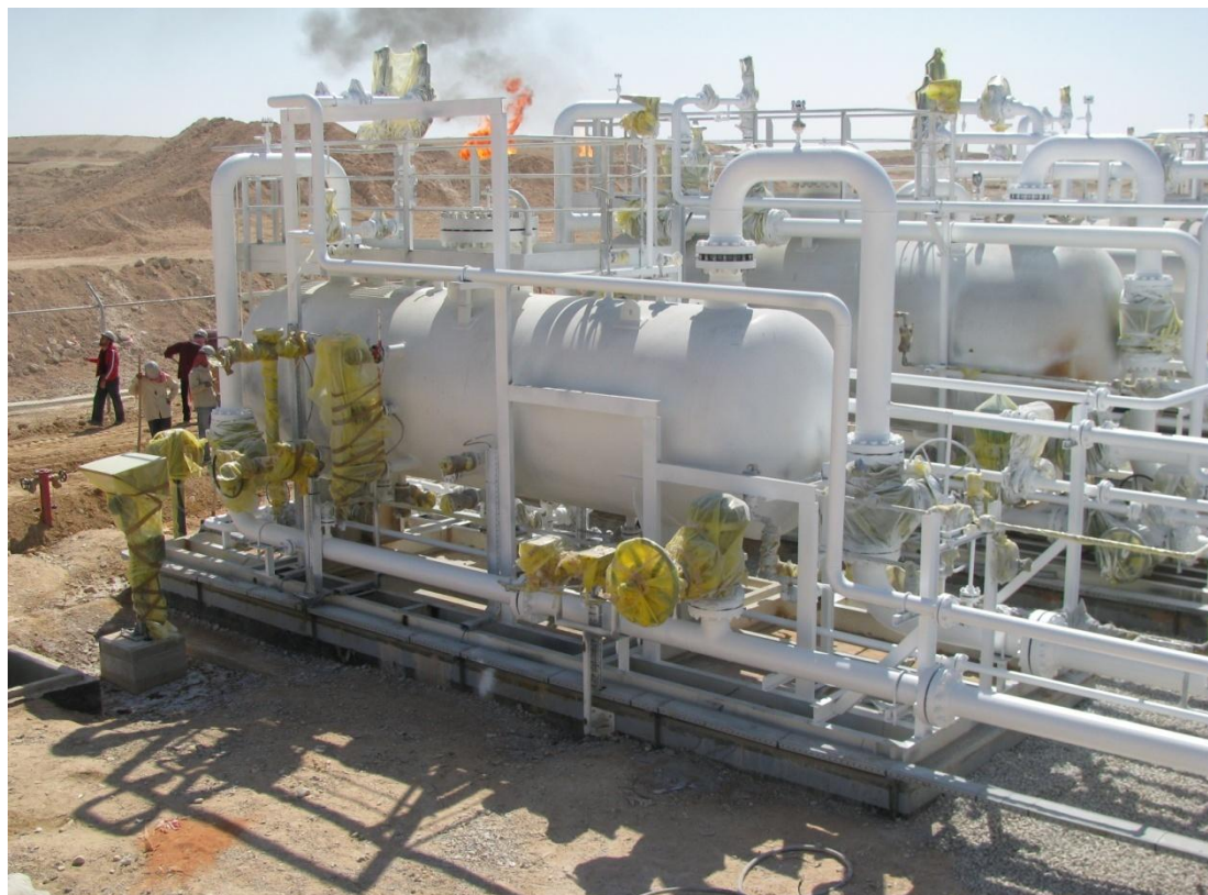
Slika 5.12 Visokotlačni separator spojen na postrojenje Jihar Faza 2
