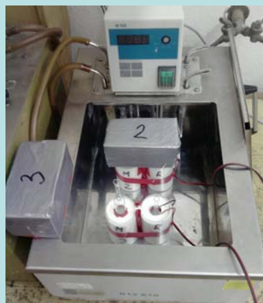
Slika 4. Određivanje konstante propusnosti topline, \alpha [ J^\circ C/h ] diferencijalnog kalorimetra
