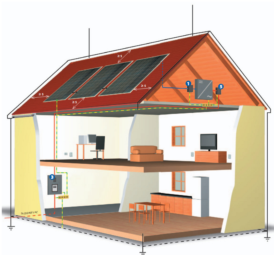
Slika 25. FN sustav na kući sa gromobranskom instalacijom
