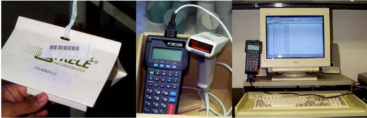
Slika 19. Delta mamak s bar kodom, laser scanner i kompjuterska baza podataka
