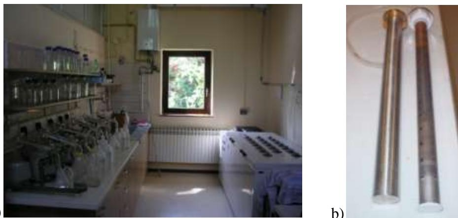
Slika 1. a) Uređaj za primarnu destilaciju uzoraka voda (lijevo) i uređaj za elektrolitičko obogaćenje (desno); b) celija za elektrolizu vode
