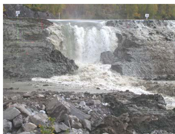
Slika 3. Presjek homogenog glinenog nasipa podvrgnutog rušenju (Hoeg i sur., 2004)
