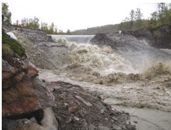
Slika 4. Fotografije nastale za vrijeme testa rušenja glinenog nasipa
