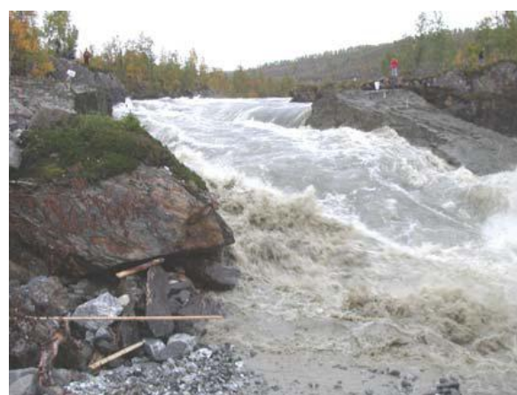
Slika 4. Fotografije nastale za vrijeme testa rušenja glinenog nasipa
