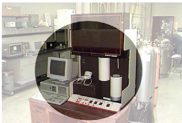
Slika 3.5. Uređaj za određivanje raspodjele veličina pora, Micromeritics-ASAP 2000
