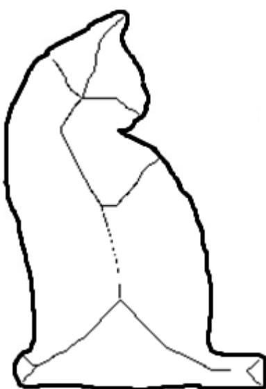
Slika 4.3.6. primjer kostura kod modificiranog Stentifordovog algoritma za sliku "maca.jpg"
