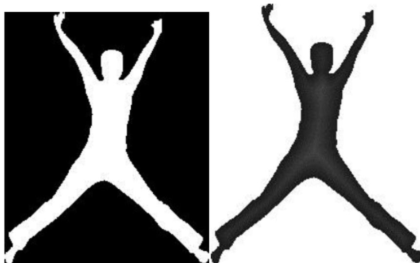
Slika 3.1.1. primjer algoritma transformacije udaljenosti, izvorna slika lijevo, mapa udaljenosti desno
