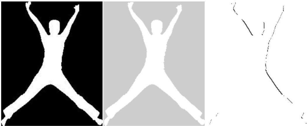
*Slika 3.1.8. primjer rekonstrukcije slike 3.1.1., izvorna slika lijevo, rekonstruirana slika u sredini, pogreške rekonstrukcije desno*
