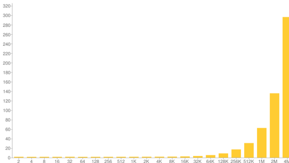
Slika 5.6: Prosječno vrijeme trajanja slanja poruke za mehanizam pmrpc - do 8MB. Os apcisa označava količinu prenesenih informacija, os ordinata prosječno trajanje prijensa.
