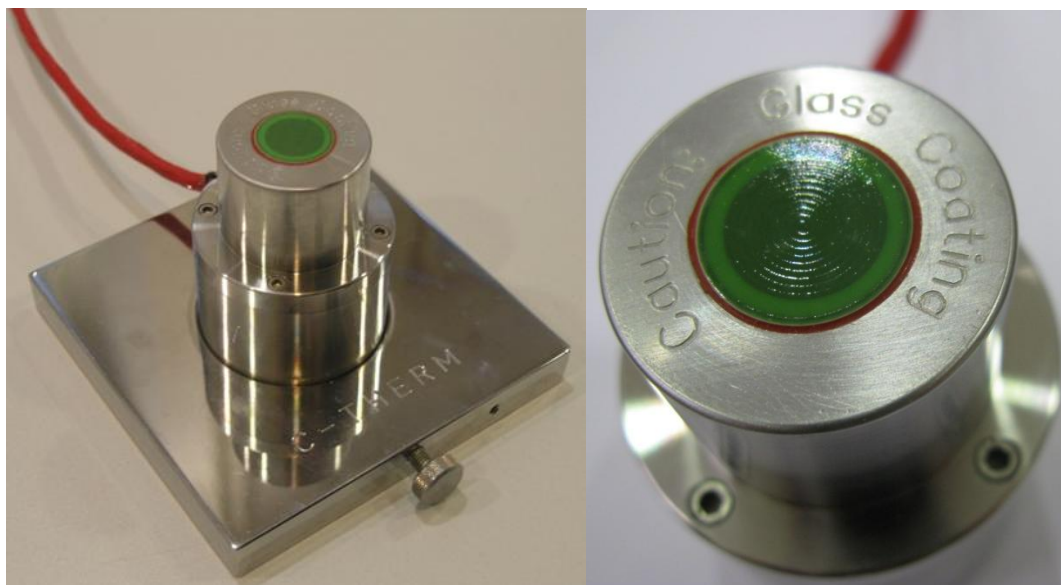
Slika 32. Ravninska spirala u senzoru
