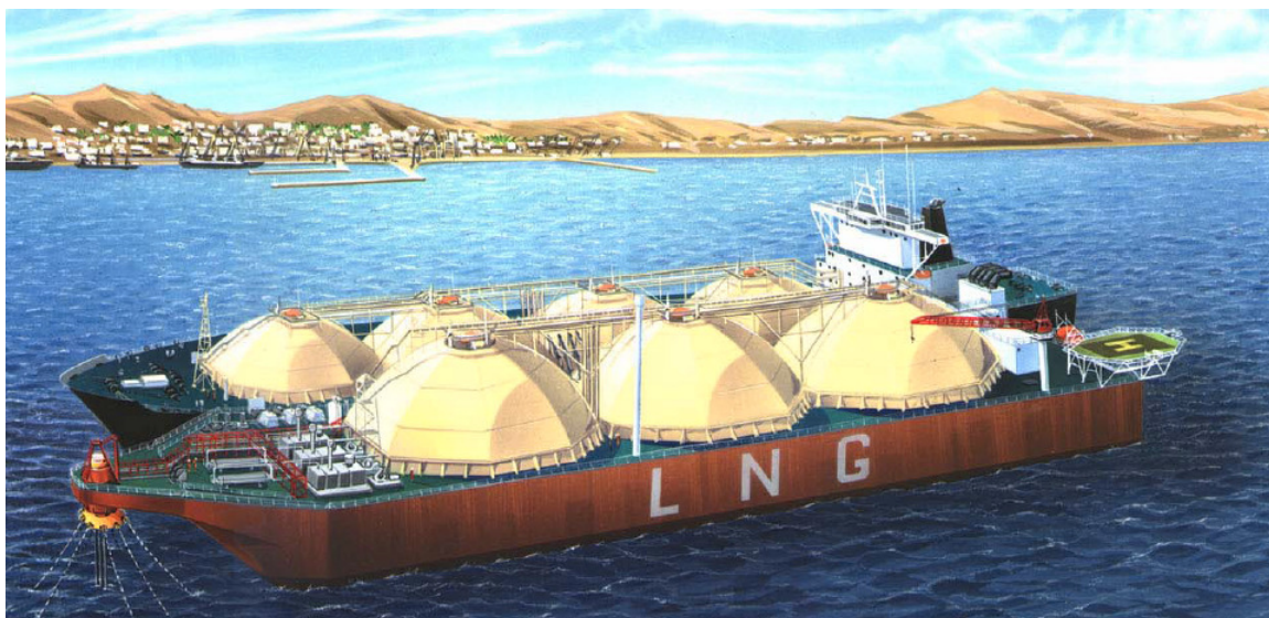
Slika 3-11. Iskrcaj UPP-a s broda na plutajuće postrojenje za skladištenje i ukapljivanje (Mossmaritme 2005).
