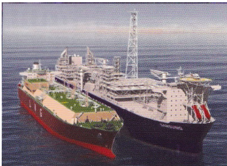
Slika 3-14. Bočni prihvat brod za transport UPP-a na prihvatni terminal (Golar 2011).
