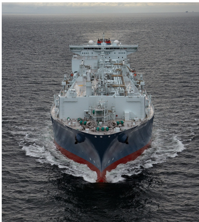
Slika 3-1. Brod za transport UPP-a sa sustavom za uplinjavanje (Proštenik; Frančić 2011).
