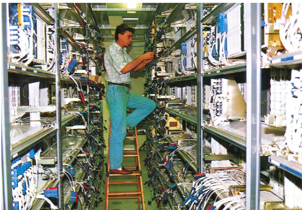
Montaža AXE-10 centrale (Tvornica „Nikola Tesla“ – Zagreb)
