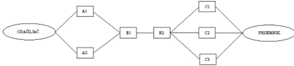
Vjerojatnost da se pokvare dijelovi  $A_1$  i  $A_2$  je  $p_A$ ,  $B_1$  i  $B_2$  je  $p_B$ ,  $C_1$ ,  $C_2$  i  $C_3$  je  $p_C$ . Kanal je prekinut ako nema veze između odsiljača i prijemnika. Izračunajte vjerojatnost da kanal bude prekinut.
