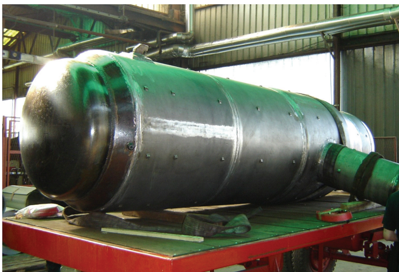
Slika 2.7: Posebno izrađen mikser iz materijala SA516 Gr.70, INCOLOY 800H, INCONEL 600
