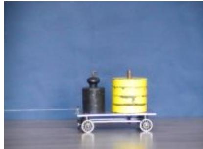
*Slika 5.1 – Kolica s četiri žuta utega od po 0,56 kg i jednim utegom od 0,50 kg.*
