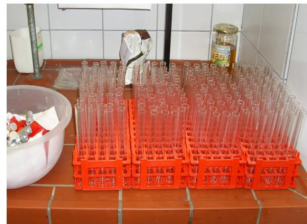
**Prilog 8** Čiste epruvete spremne za ulijevanje agara
