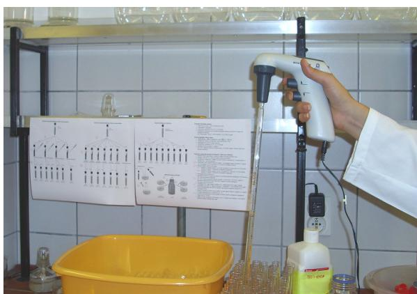
Slika 8 Ulijevanje agar-a u epruvete
