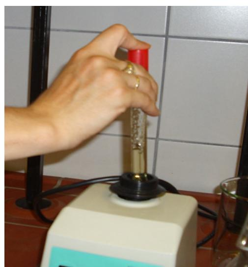
Slika 17 Homogenizacija uzorka (agar + patogena bakterija)
