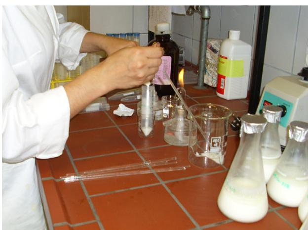
**Slika 12** Uzimanje uzorka za mjerjenje pH vrijednosti u sterilnim uvjetima
