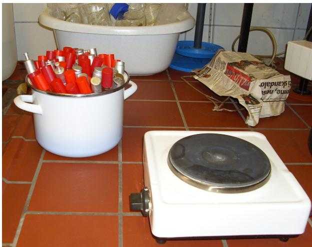
**Slika 10** Zagrijavanje steriliziranog agaru u vodenoj kupelji na 100 °C
