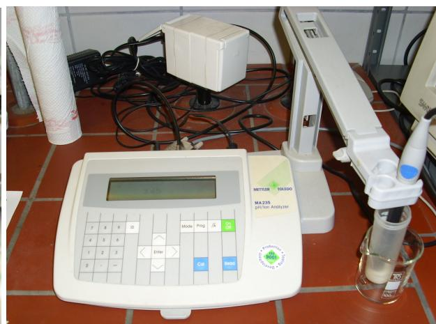
**Slika 13** Mjerjenje pH uzorka
