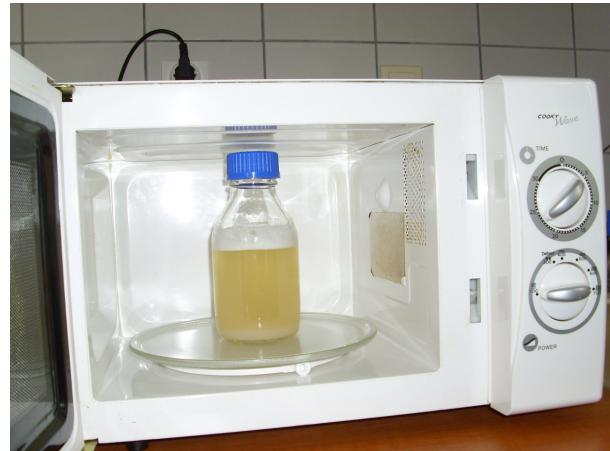
Slika 7 Zagrijavanje agar-a u mikrovalnoj pećnici
