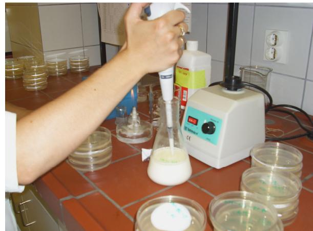
**Slika 19** Uzimanje uzoraka (pipetom) za nacjepljivanje
