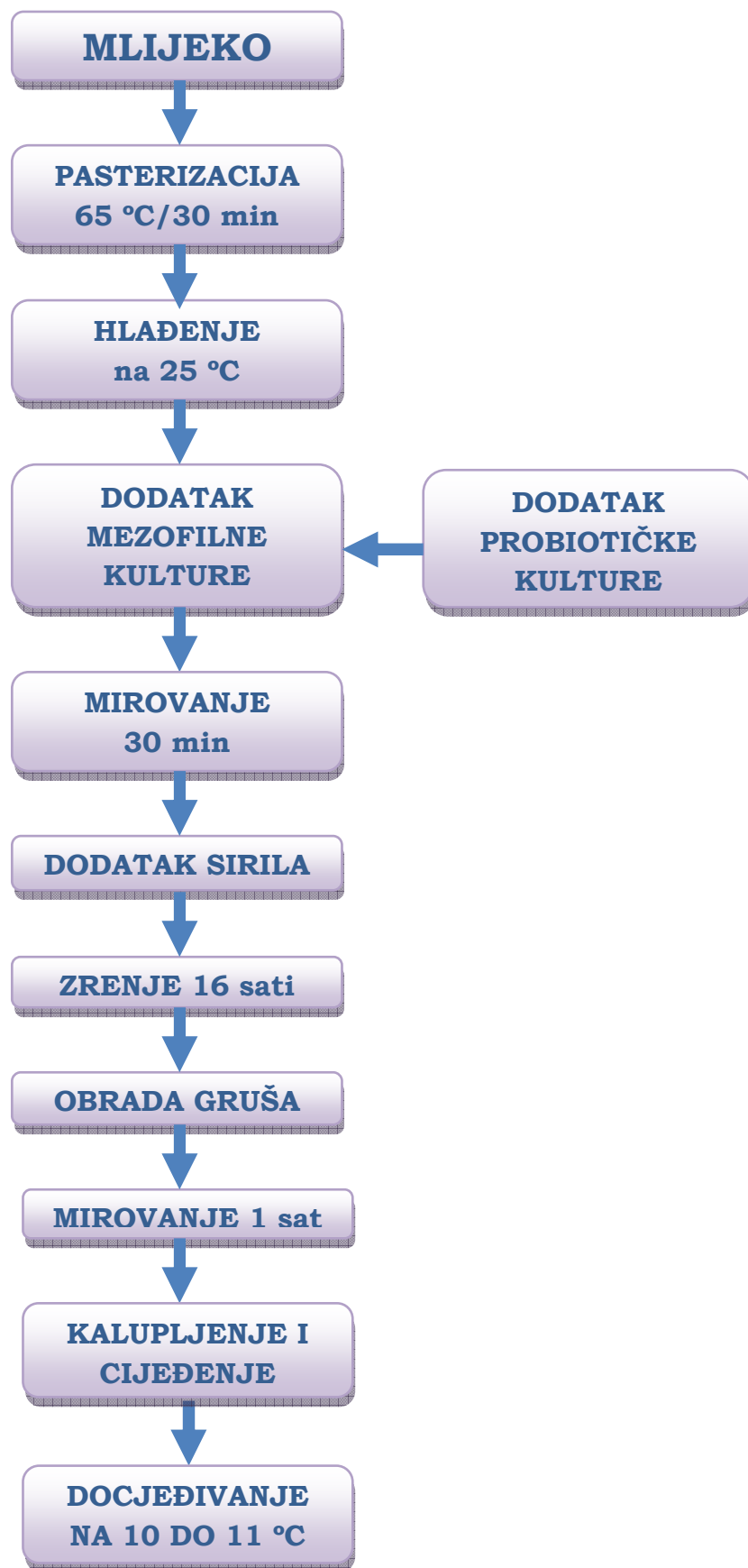
Slika 8 Shema proizvodnje industrijskog svježeg zrenatog sira [9]
