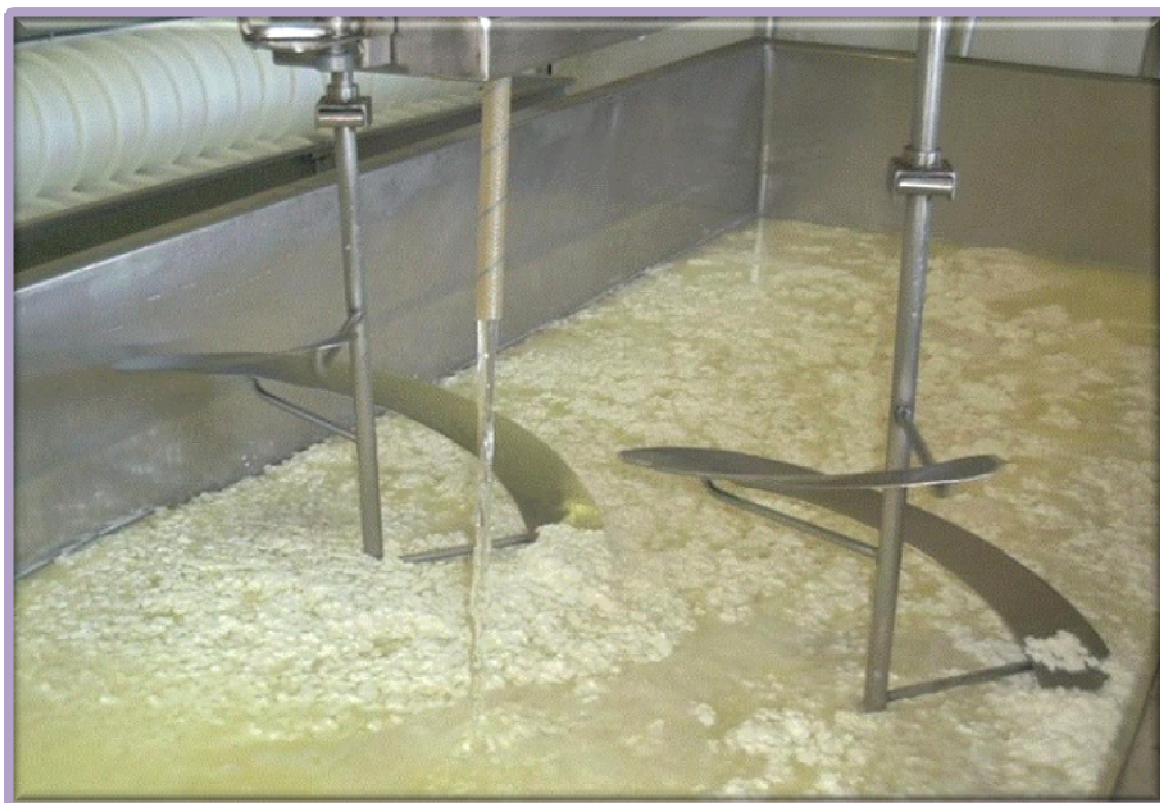
Slika 6 Ispiranje (sušenje) sirnog gruša [8]
