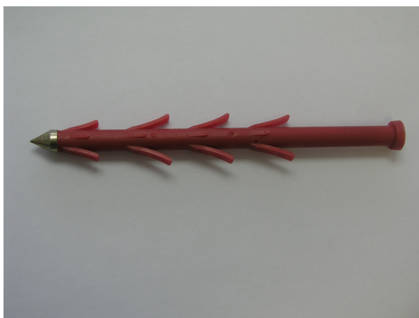
Slika 12. Metalni klin za obilježavanje središta plohe (Indir, 2004)
