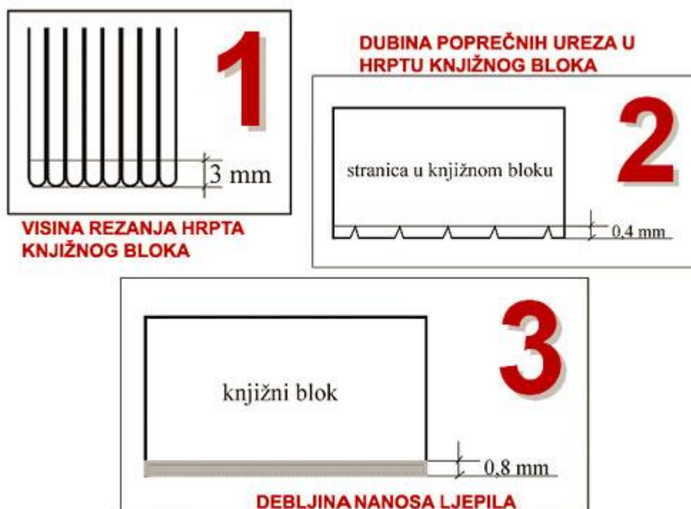
Slika 10.: Prikaz redoslijeda tehnoloških operacija obrade hrpta knjižnog bloka
