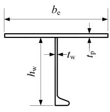
Figure 2 **Deck stiffener** Slika 2 **Uzdužnjak palube**
