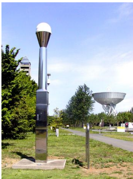
Sl. 1. Stup permanentne GPS-stanice
