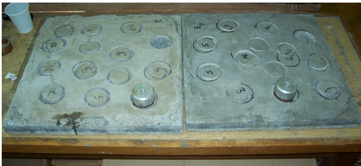
Slika 10. Primjer pripreme uzoraka za ispitivanje adhezijske čvrstoće pripravljenog morta na substratu od portland cementnog betona.
