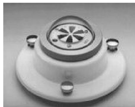
Slika 3. Zvjezdasti piranometar tipa "Schenk" [<http://solardat.uoregon.edu/SchenkStar.html>]
