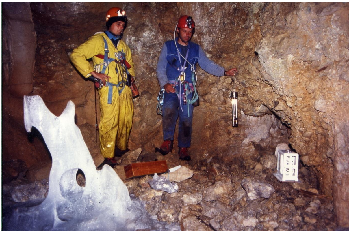
Slika 1. Boris Vrbek i autor mjere temperaturu i relativnu vlažnost zraka u Ledenoj jami u Lomskoj dulibi (Sjeverni Velebit) 1996. g. pomoću bimetalnog termohigrografa baždarenog Assmanovim psihrometrom. Istraživanje je bilo dio projekta istraživanja flore na ulazima spilja i jama koji je vodila Suzana Fiedler u suradnji s Mirjanom Vrbek (HPM). Foto B. Vrbek.
