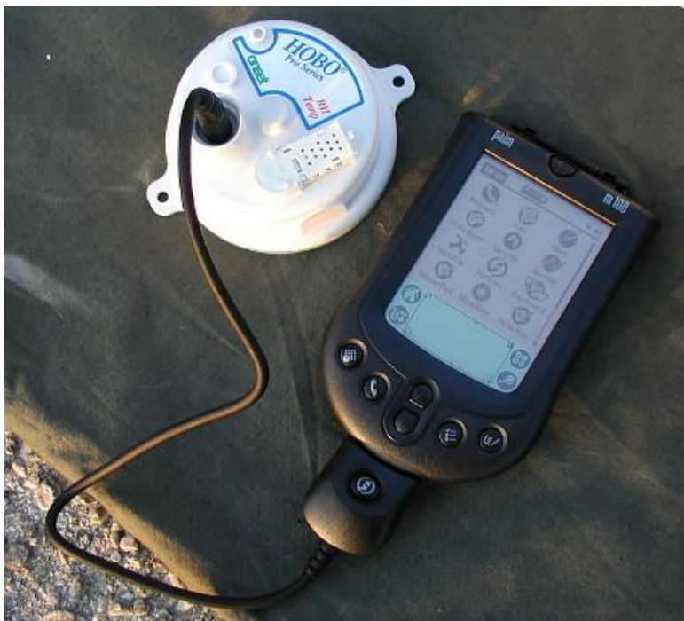
Slika 2. Memorijski termohigrograf HOBO Pro RH/Temp (Onset) prvi put je za mjerenje u Hrvatskoj korišten 2002. godine u Veloj spili (Korčula). Osim na stolnom računalu može se programirati i putem Palm ručnog računala. Figure 2. Thermohygrograph data logger HOBO Pro RH/Temp (Onset) first time in Croatia used for cave microclimate research in 2002 in Vela spila cave (Korčula). Besides desktop computer it can be programmed with Palm handheld.
