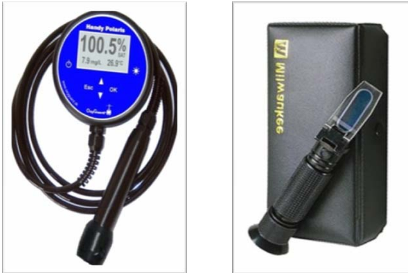
Slika 3.12. Instrumenti korišteni za prikupljanje podataka o otopljenom kisiku, temperaturi i salinitetu
