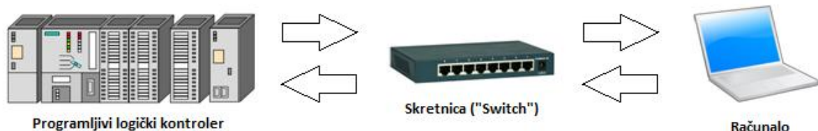
Slika 2. Komunikacija između programirajivog logičkog kontrolera i računala
