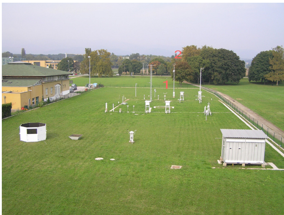
Slika 2.1 Prikaz mjernih instrumenata, uključujući stupove s anemometrima na 2 m (oznaka 1) i 10 m visine (oznaka 2) kao i neposrednog okoliša mjesta za specijalna mjerenja na opservatoriju Zagreb-Maksimir. Pogled je približno u smjeru sjevera.
