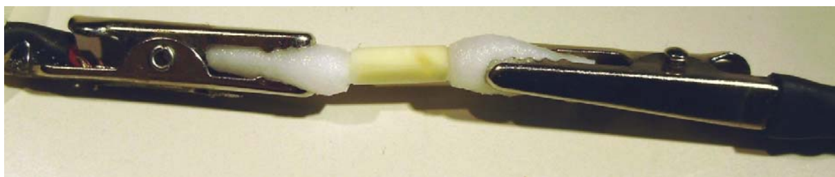
Slika 4.2. Spoj dentina na mjerne elektrode ostvaren preko dvaju pamučnih štapića natopljenih u fiziološku otopinu.
