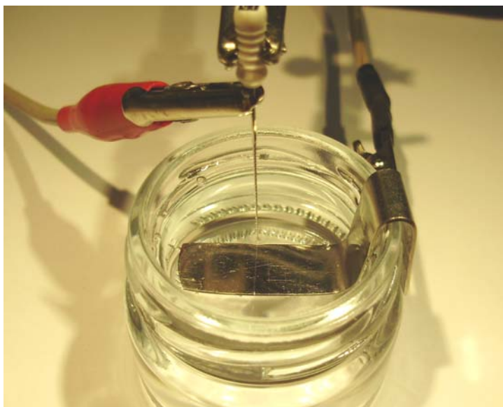
Slika 4.13. Mjerni postav pri mjerenju impedancije spoja Kerrovog instrumenta na fiziološku otopinu.
