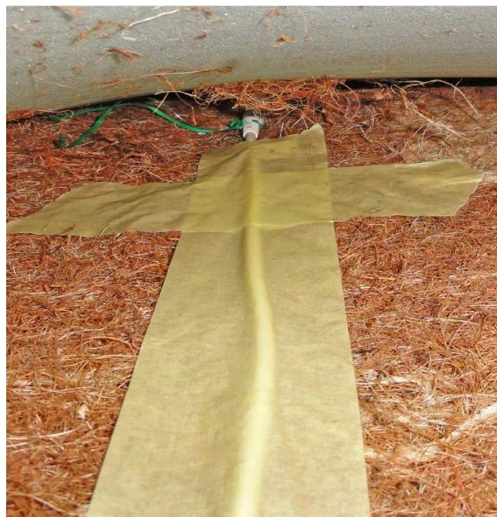
**Slika 16.** Prikaz sonde postavljene između PU spužve i lateksiranog kokosa
