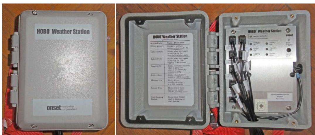
**Slika 12.** Prikaz uređaja uređaja *HOBO® Weather Station H21-001*
