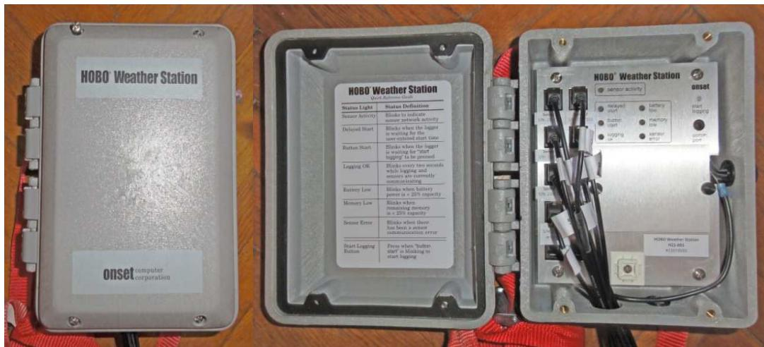
**Slika 11.** Prikaz uređaja *HOBO<sup>®</sup> Weather Station H21-001*
