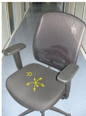
**Model MA (Med Art 10).** Sjedalo modela MA bilo je debljine oko 55 mm od PU hladno lijevane spužve označe kvalitete 4040 s gustoćom od 40 kg/m<sup>3</sup>. Glavna karakteristika sjedala je bila elastična veza s mehanizmom pomoću patentiranog sustava *Body Balance Tec*<sup>®</sup> što mu je omogućavalo trodimenzionalno gibanje (slika 23.).
