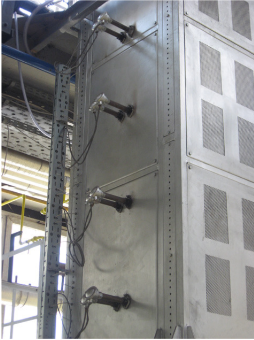
Slika 6.37. WIKA Pt10%Rh-1600°C termoparovi raspoređeni u četiri grijane zone
