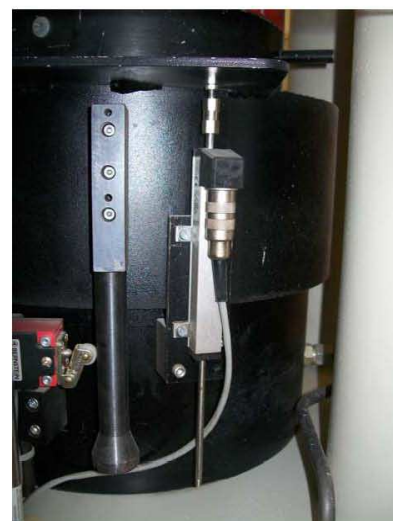
Fotografija 5.7. Prikaz hidraulične preše i LVDT uređaja za mjerenje pomaka
