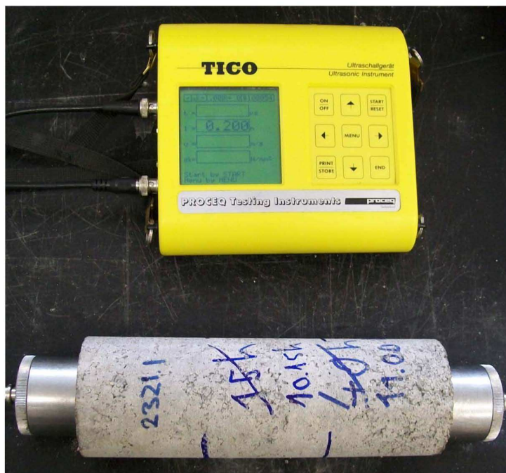
Fotografija 5.10. Uzorak s uređajem za mjerenje dinamičkog modula elastičnosti
