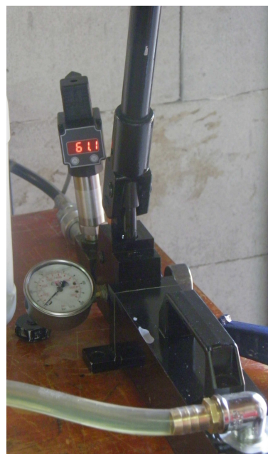
Fotografija 6.3. Prikaz hidrauličnih cilindara (H1) i digitalnog mjerača tlaka
