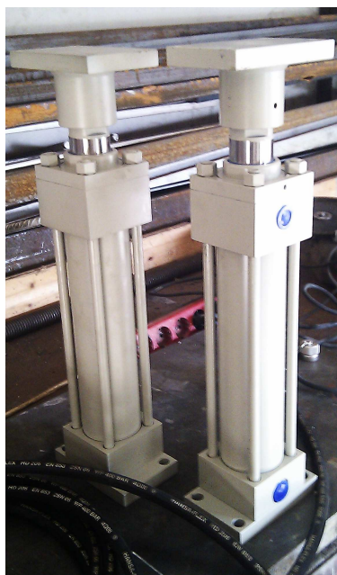
Fotografija 6.3. Prikaz hidrauličnih cilindara (H1) i digitalnog mjerača tlaka
