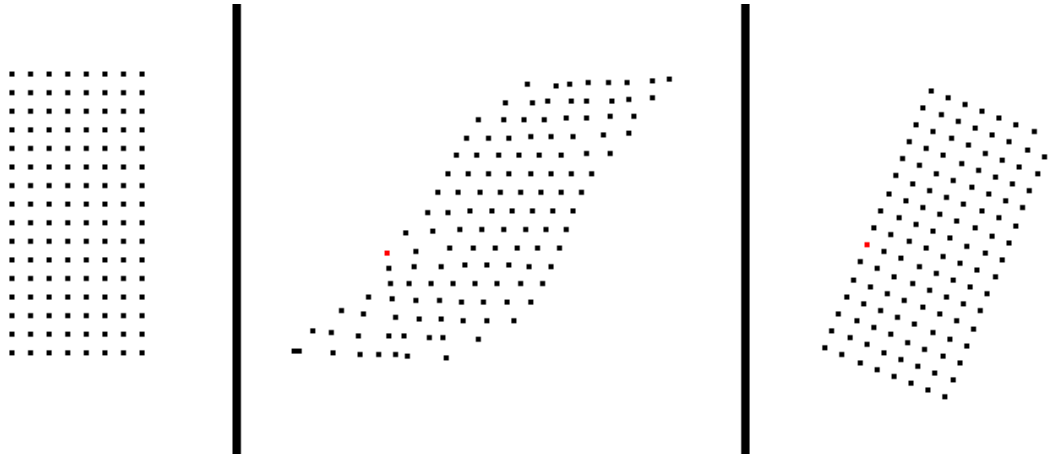
Slika 3 – Primjer određivanja kuta rotacije tijela: početni položaj (lijevo), deformiranje (sredina) te konačan položaj nakon što završi titranje (desno)
