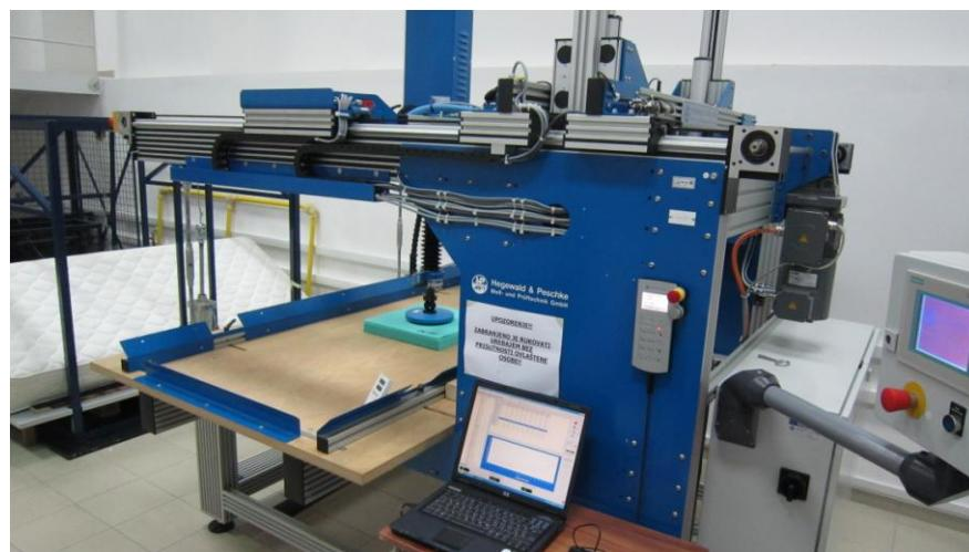
Slika 11. Prikaz uređaja za ispitivanje mehaničkih svojstava spužvi
