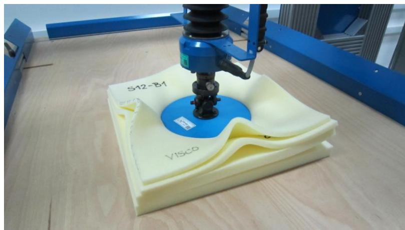
Slika 12. Prikaz utiskivanja pritisnog tijela u uzorak
