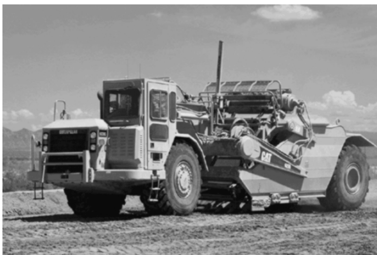
Slika 8.13 Noviji model skrepera s vlastitom vučom
