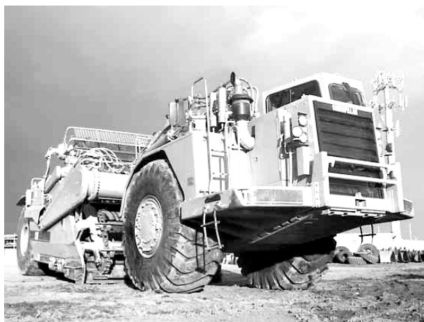
Slika 10.3 Skreper za iskop i prijevoz gradilištem na udaljenosti do 800m.
