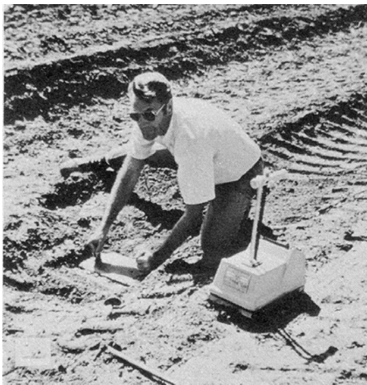
Slika 11.92 Mjerenje gustoće tla nuklearnim densimetrom
