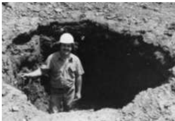
Slika 11.21 Veličina rupe koja nastaje pri udaru tereta o tlo
