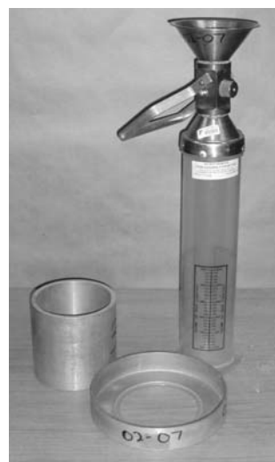
Slika 11.94 Pokus s kalibriranim pijeskom, u sredini shema, desno uređaj
