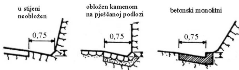
Slika 13.6 Rigoli u nožici pokosa usjeka ili zasjeka
