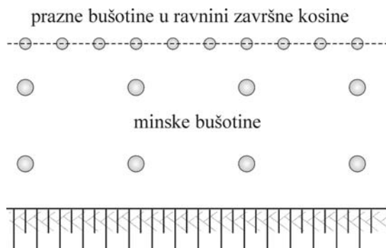
Slika 9.19 Konturno miniranje linijskim bušotinama
