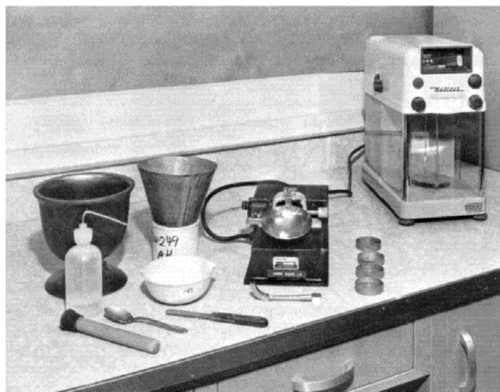
Slika 4.7 Pribor za ispitivanje granice tečenja
