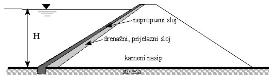
Slika 11.78 Nasip s nepropusnom membranom na uzvodnoj strani
