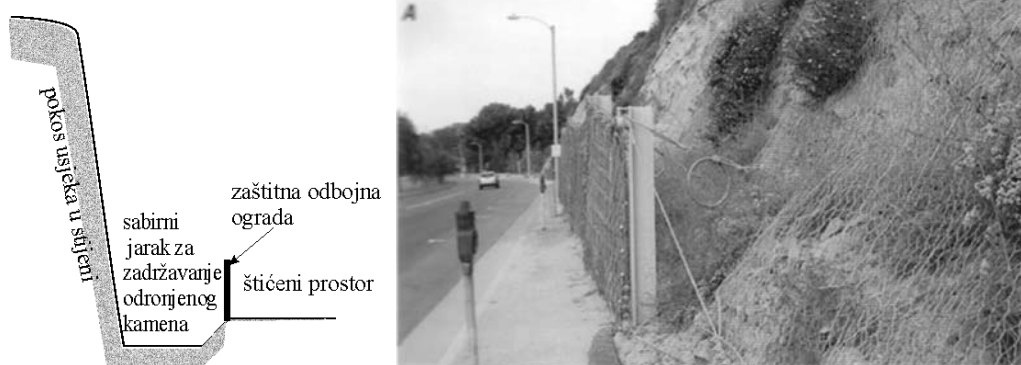
Slika 14.5 Jarak za hvaranje komada i mreže za razbijanje energije odronjenog kamena s pokosa usjeka (Geobrugg)
