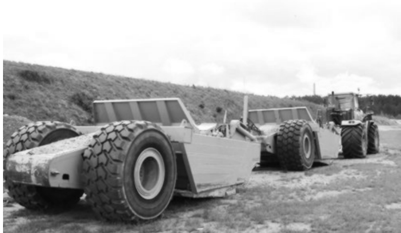
Slika 8.14 Skrejšper vučen traktorom s dva sanduka
