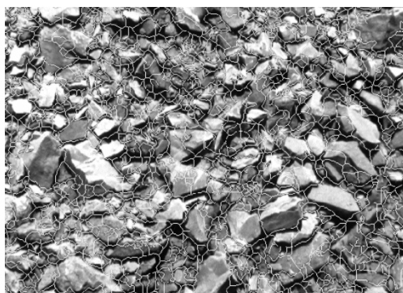
Slika 9.11 WipFrag – automatski generirana mreža fragmenata (Lukić 2011.)
