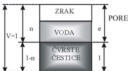
Slika 4.14 Model trodjelnog sustava tla
