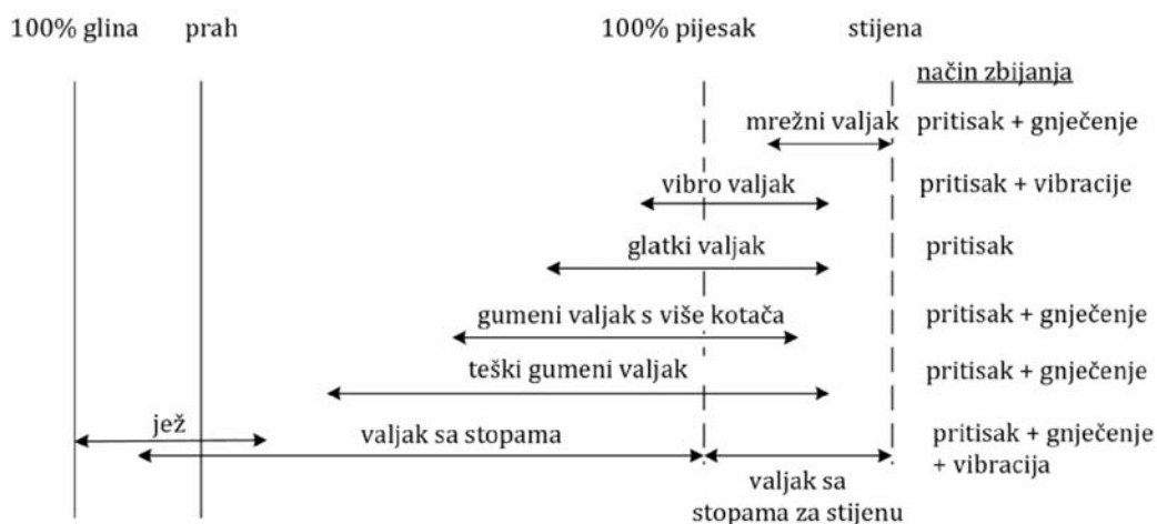
Slika 11.62 Prilagodba strojeva za zbijanje vrsti tla (Coduto 2010.)
