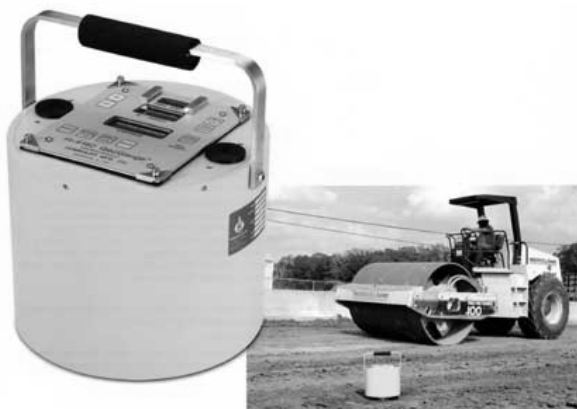
Slika 11.91 Elektronska zamjena za probnu ploču
