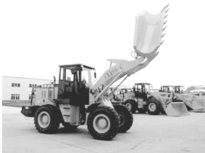
Slika 8.18 Utovarivač s zaokretnim košem
