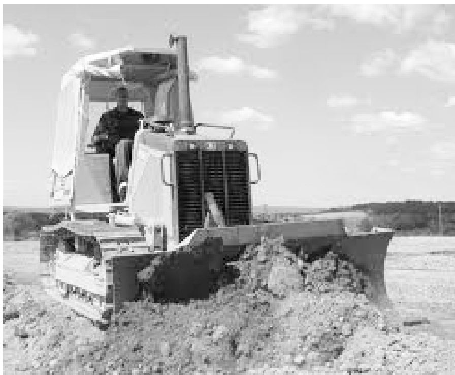
Slika 10.2 Buldozer za guranje iskapanog tla na manje udaljenosti
