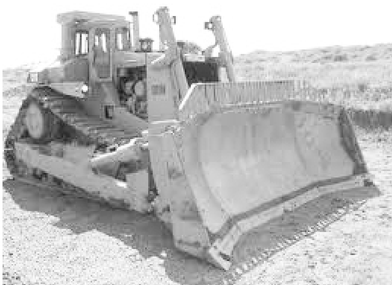
Slika 8.5 Buldozer sa zakrivljenim nožem
