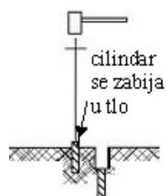
Slika 11.93 Uzimanje uzorka cilindrom iz nasipa
