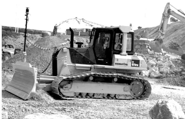
Slika 11.53 Angldozer za razastiranje i guranje tla istovarenog na hrpe
