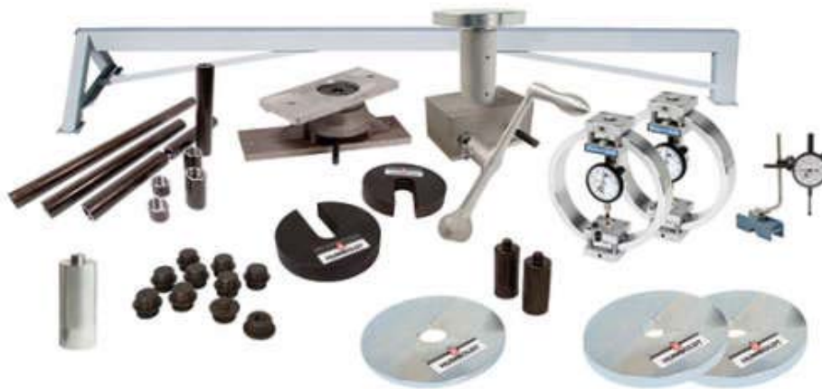
Slika 4.26 Oprema za CBR pokus na terenu
