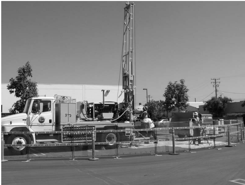
Slika 3.15 Bušači stroj na kamionu
