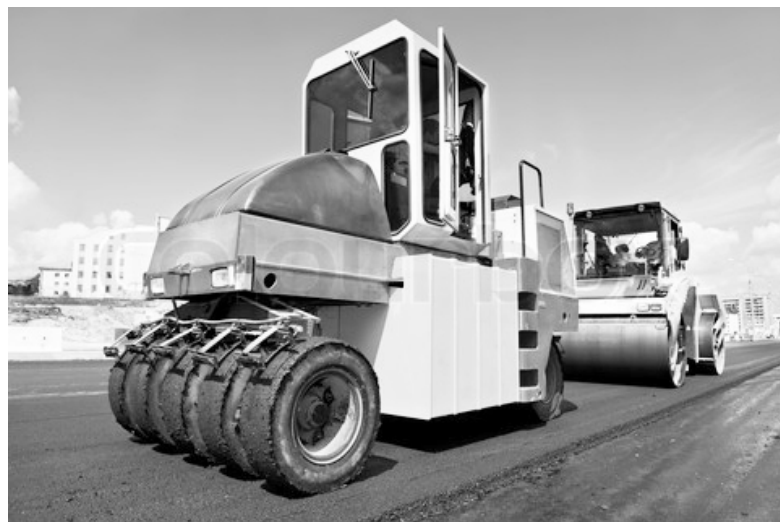
Slika 11.60 Vibroploča, valjak s gumenim kotačima i glatki valjak
