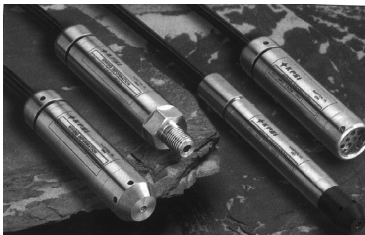
Slika 3.16 Čelije za elektronsko mjerenje pornih tlakova u bušotini
