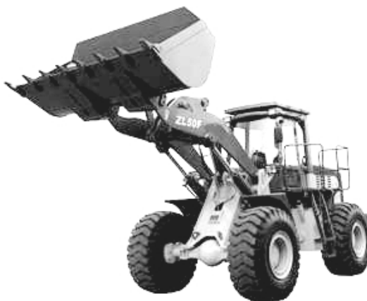
Slika 8.17 Utovarivač na kotačima
