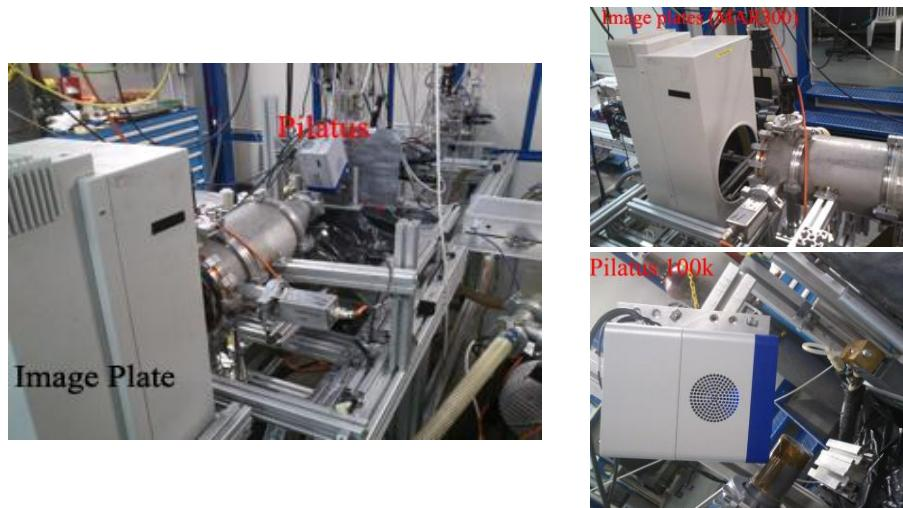
**Slika 15.** Eksperimentalni postav za prikupljanje SAXS i WAXS signala na Austrijskoj SAXS liniji na Sinhrotronu Trieste.
