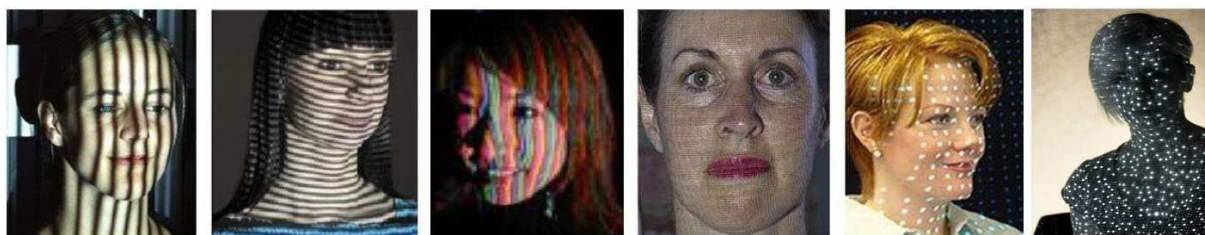
Slika 2.12: Primjer nekoliko struktura koje projiciraju skeneri sa strukturalnim svjetlima
