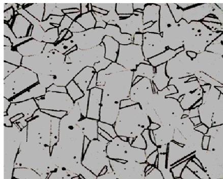
Slika 3. Mikrostruktura austenitnog čelika (povećanje 100:1) [3]
