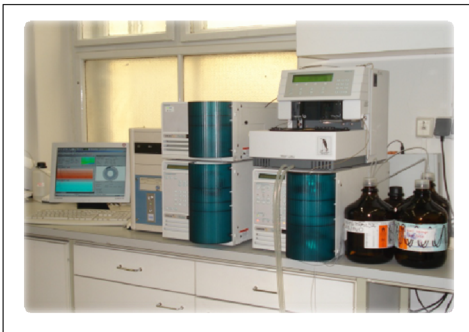
Slika 15. Tekućinski kromatograf visoke djelotvornosti, Varian ProStar 500, s detektorom s nizom dioda (HPLC-DAD)
