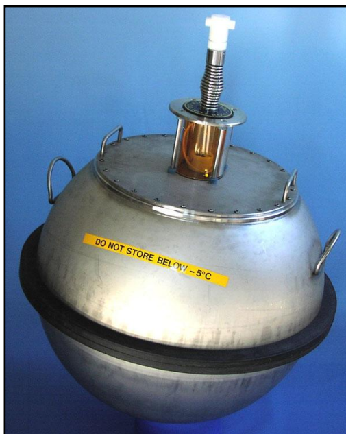
Slika 2.1. Nedirekcionni valograf tvrtke Datawell iz 70 – ih godina
