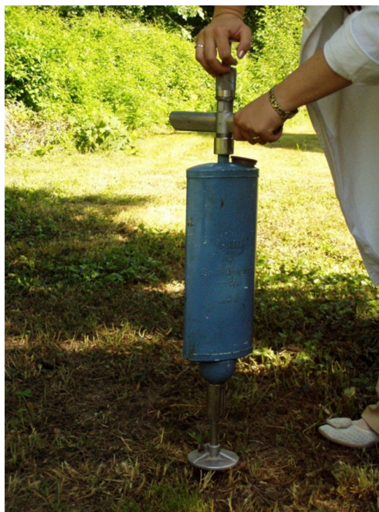
Slika 1. Ubrizgavanje insekticida u tlo u zoni korijena pomoću uređaja “Shell-Soil Fumigant Injector Model HI” (snimio A. Mešić)
